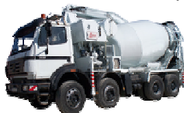
Betonszállító mixer betonszivattyúval (3326)
